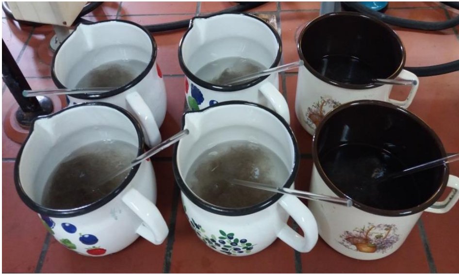
Slika 16. Vuneni uzorci u lončićima s mekom vodom i sredstvom za kvašenje
