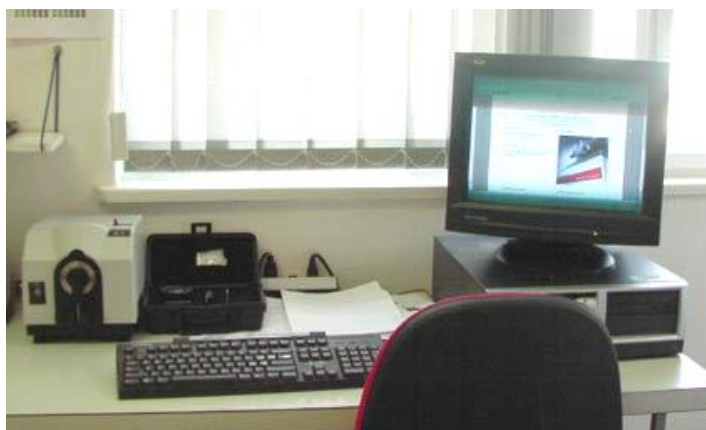
Slika 18. Remisijski spektrofotometar Spectraflash SF 300, tt. Datacolor [i]
