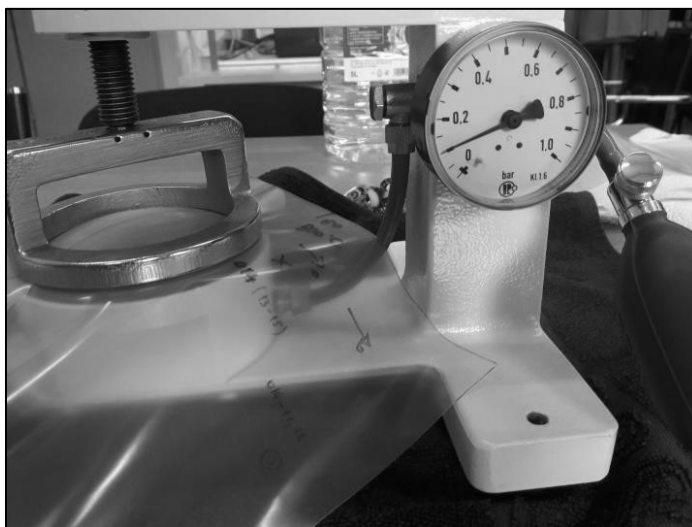
Sl. 3.23 Prijenosni uređaj za određivanje zrakonepropusnosti uzorka materijala i spoja
