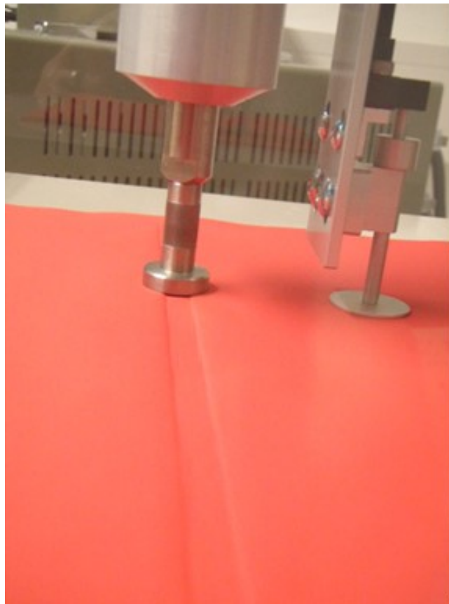
Sl. 4.56 Mjerenje kompresijskih svojstava
