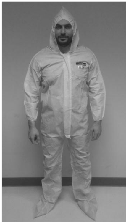
Sl. 2.16 Kemijsko zaštitno odijelo TIP 5 izrađen kombinacijom tehnike šivanja i tehnike toplinskog spajanja konvekcijom, spajanjem adhezivne trake po šavu, (Vinches i Halle, 2017)
