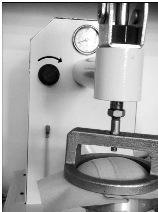
Sl. 3.24 Prikaz uređaja za ispitivanje vodonepropusnosti spojeva
