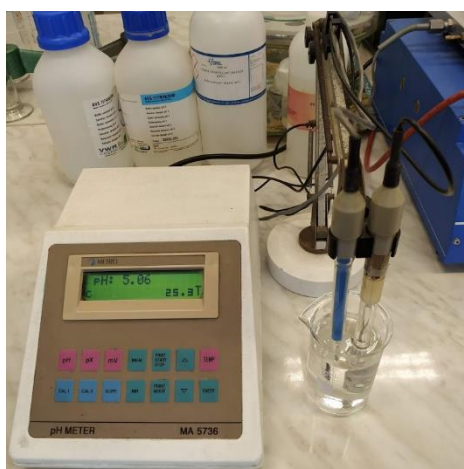
Slika P6.3. pH metar, Metrel
