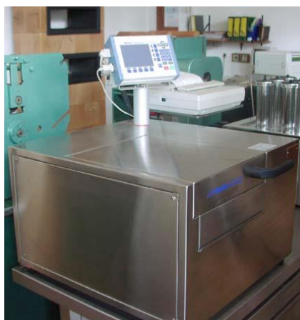
Slika P6.2. Laboratorijski uređaj za obradu materijala Polymat, Mathis
