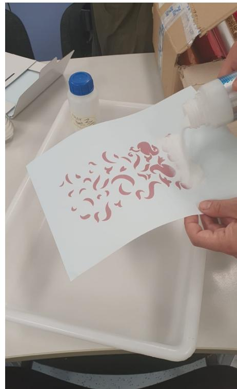
Sl.28 nanošenje termoplastični prah
