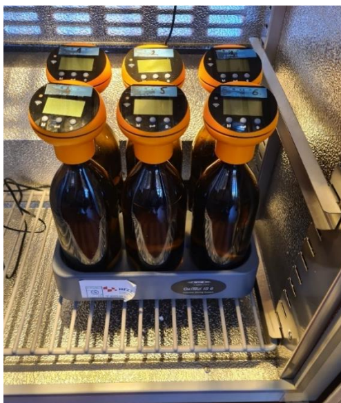
Slika 11. OxiTop mjerni sustav
