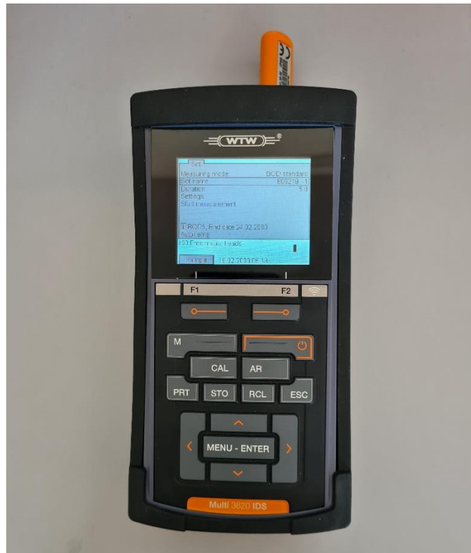
Slika 14. Multimetar Multi 3630/ 3620 IDS
