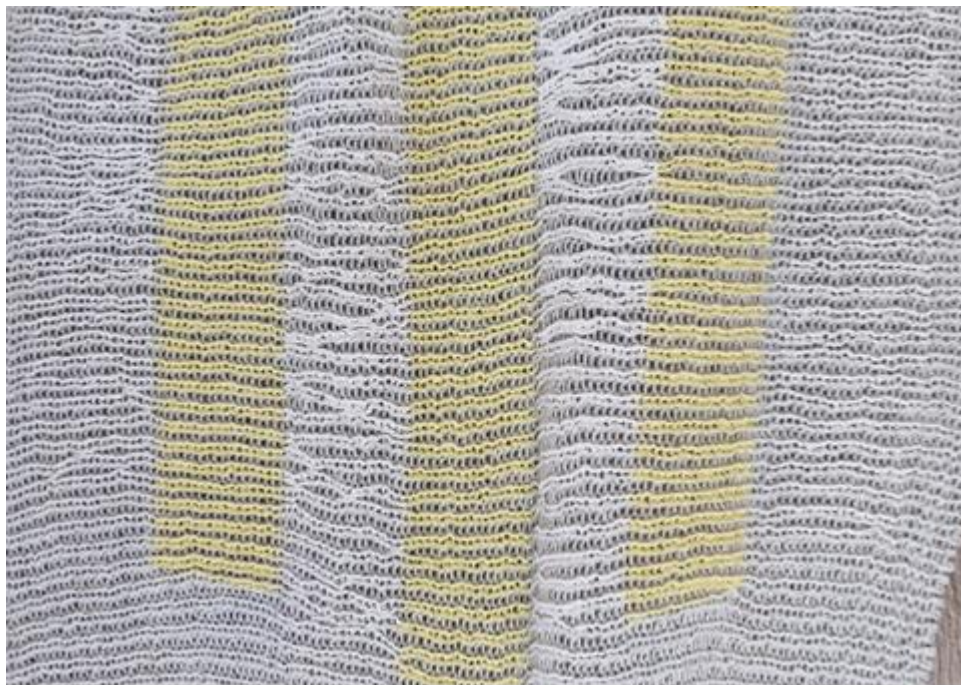
Slika 32.b. Izgled otiska na uzorku br.7 pletiva prilikom rastezanja pletiva [46]
