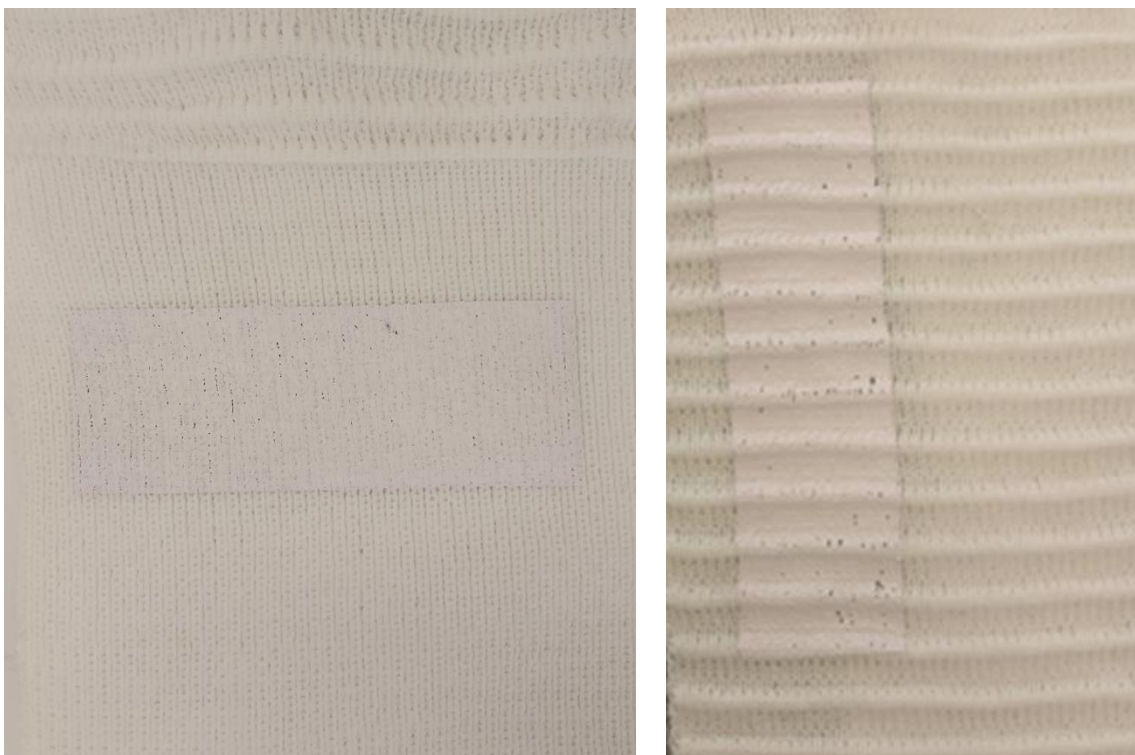
Slika 14.a) Bijeli otisak na uzorku br.2 [15] Slika 14.b) Bijeli otisak na uzorku br.3 [16]
