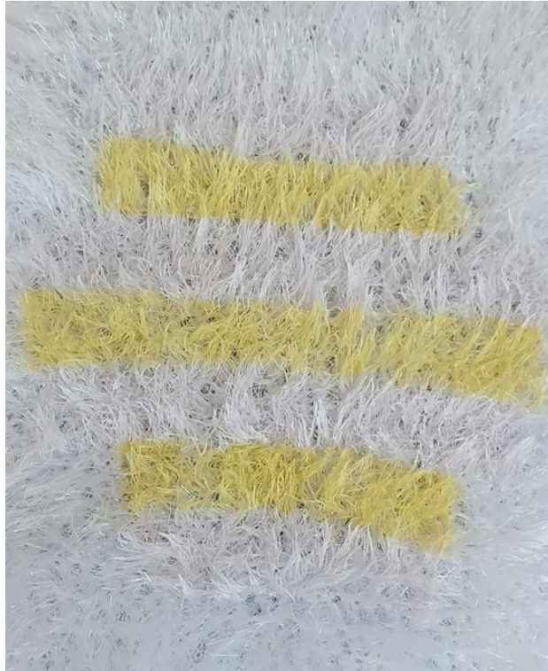
Slika 28.a. Dvobojni otisak tehnikom sitotiska na uzorku br.3 pletiva s efektom pređom [37]
