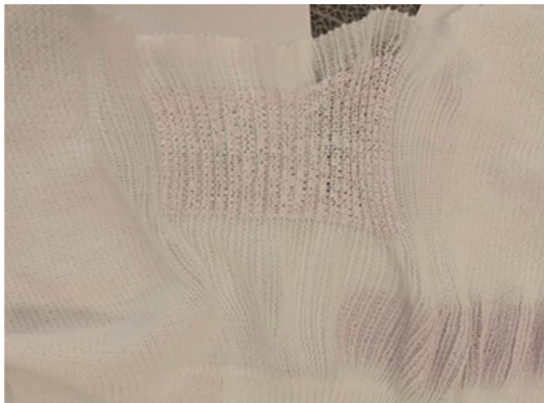
Slika 15.b. Efekt nabiranja nakon otiska na desno-desnom glatkom pletivu [18]
