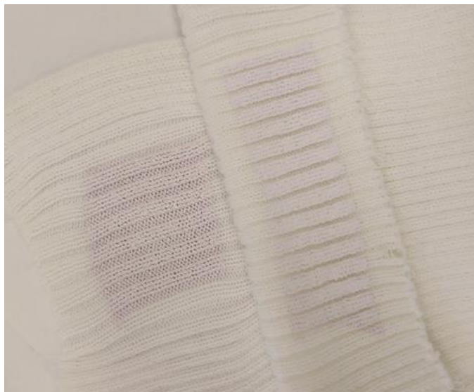
Slika 17. Otisak na uzorcima rebrastog pletiva u rastegnutom (lijevi uzorak) i opuštenom stanju (desni uzorak) [20]
