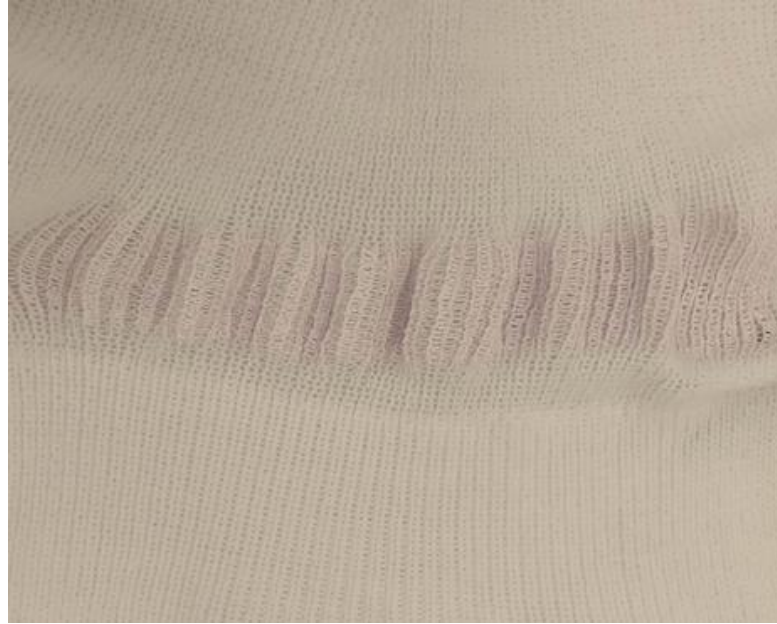
Slika 15.a. Efekt nabiranja nakon otiska na desno-desnom glatkom pletivu [17]
