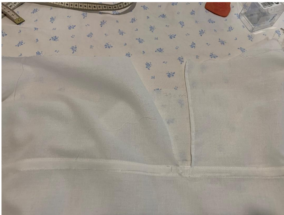
Slika 29 Šivanje kose trage za pravljenje tunela za vezinu na liniji struka
