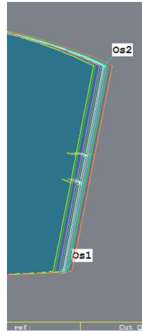
Slika 14: Alteracija struka – stražnji dio ženskih hlača
