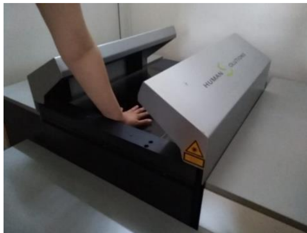
SI 3. Računalno vođen laserski 3D skener za šake i stopala PEDUS, tt. Human Solutions [6]
