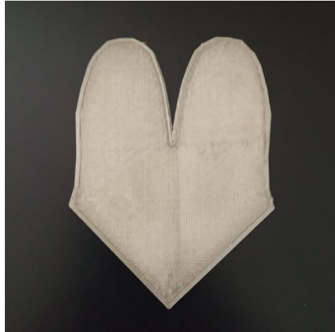
Slika 28. 3D tiskano ojačanje za palac korišteno kao etalon
