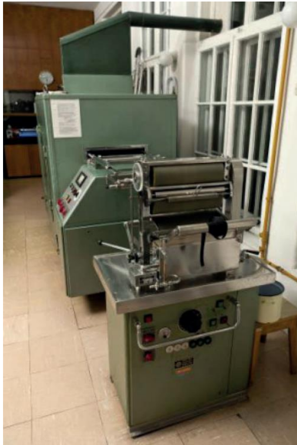
Slika 20. Rastezni sušionik s fularom tvrtke Benz
