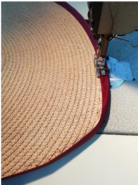
Ušivanje satenske kose trake na obod šešira
