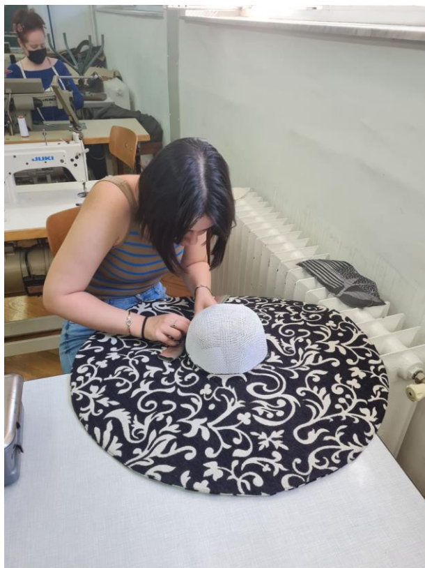
Ručno ušivanje zelene trake na mjestu spajanja oglavlja i oboda
