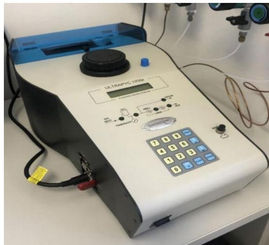
**Slika 17.** Plinski piknometar Ultrapyc 1200e
