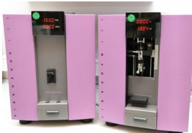
**Slika 18.** Vibroskop 500 (lijevo) i Vibrodyn 500 (desno)
