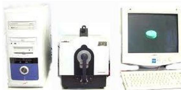
**Slika 34.** Remisijski spektrofotometar Spectraflash SF 300
