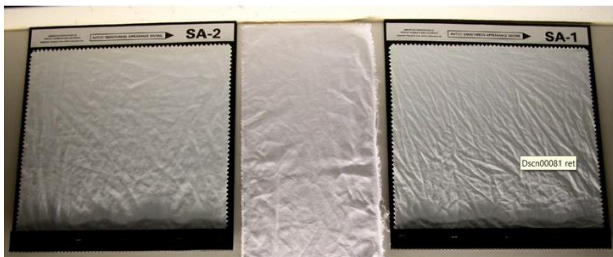
Slika 25. AATCC TM 124 replike: a. standardna replika SA-2; b. uzorak analizirane tkanine; c. standardna replika SA-1
