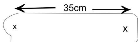
Slika 25. Krojni dio štitnika ili spojnika za ramena duljine 35 cm. Na oznakama x je spojen s prednjim i stražnjim krojnim dijelom. Krojnom dijelu nije dodan dodatak za šav.
