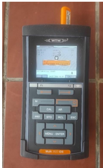
Slika 3.7. OxiTop Multi 3630/3620 IDS multimetar
