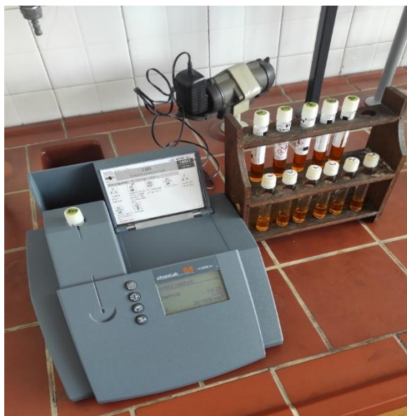
Slika 3.4. Fotometar i označeni uzorci spremni za ispitivanje KPK vrijednosti
