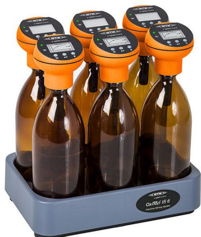
Slika 2.14. OxiTop set za određivanje BPK [35]
