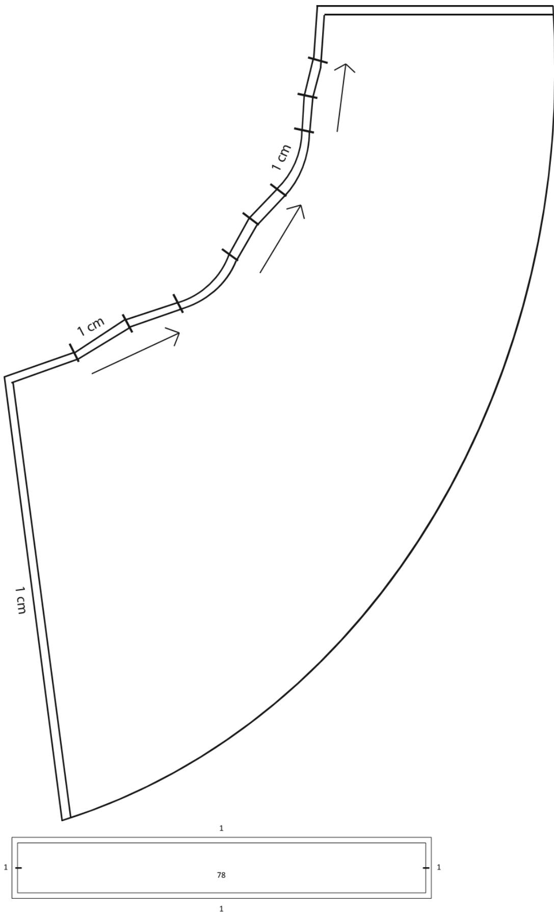
Slika 50. Izmodelirani krojni dijelovi sa dodanim šavnim dodatcima
