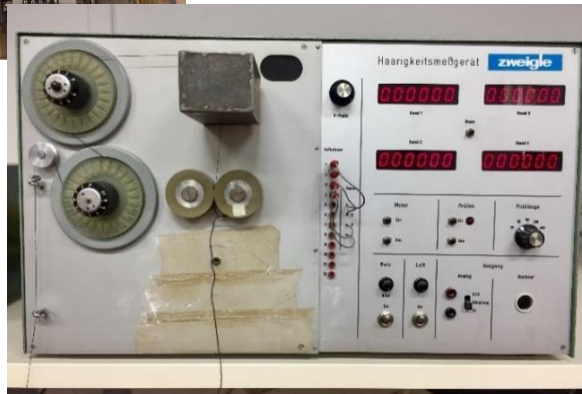
Sl. 5. Uređaju za mjerenje dlakavosti pređe tip G 565 tt. Zweigle, Njemačka
