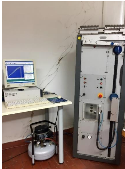
Sl. 4. Dinamometar Statimat M-tt. Textechno, Njemačka
