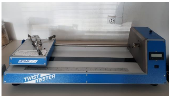
Sl. 3. Torziometar, Twister, Mesdan Lab, Italija [12]
