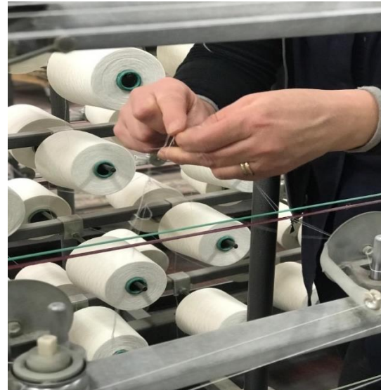
Sl. 15. Ručno spajanje niti
