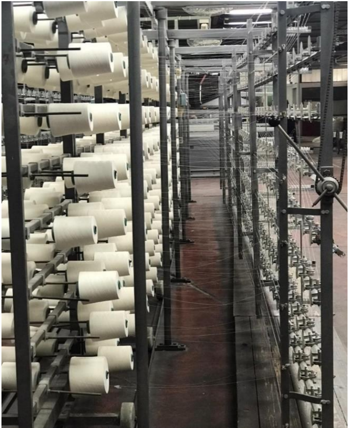
Sl. 9. Povezane niti na snovaćem stalku
