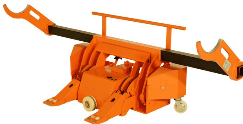
Sl. 6. Dizalica dizajnirana za transport valjaka [5]
