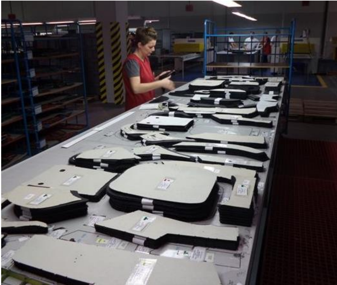
Slika 9 Sortiranje i provjera krojnih dijelova nakon faze iskrojavanja
