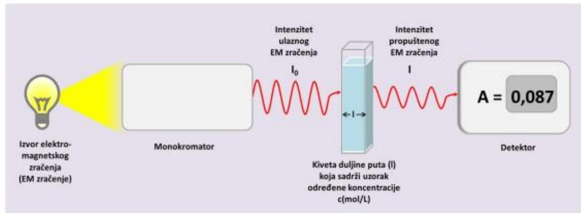
*Sl. 8. Princip mjerjenja apsorbancije na spektrofotometru [23]*
