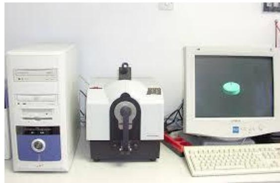
**Slika 2:** Remisijski spektrofotometar Spectraflash SF 300, tt. Datacolor
