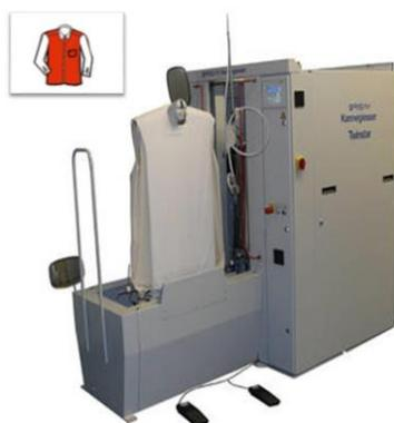
**Slika 6.** Stroj za tunelno glaćanje [17]
