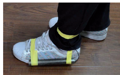
Slika 4. Linearnim generator električkog napona smještene uzduž donjišta obuće.
