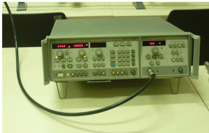
Slika 3.29. Generator signala HP 8350 B
