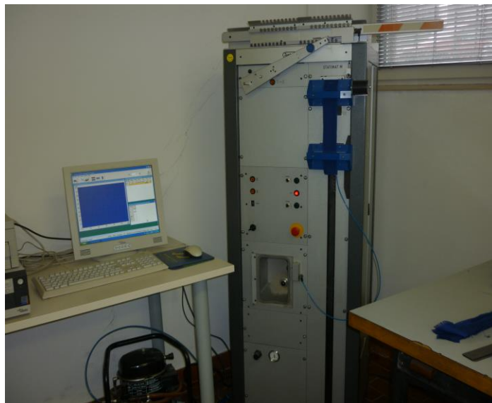
Slika 3.21. Dinamometar za pređu i plošne proizvode Statimat M, Textechno
