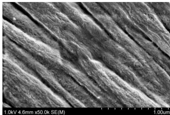
**Slika 9.** SEM mikroskopska slika pamuka [1]
