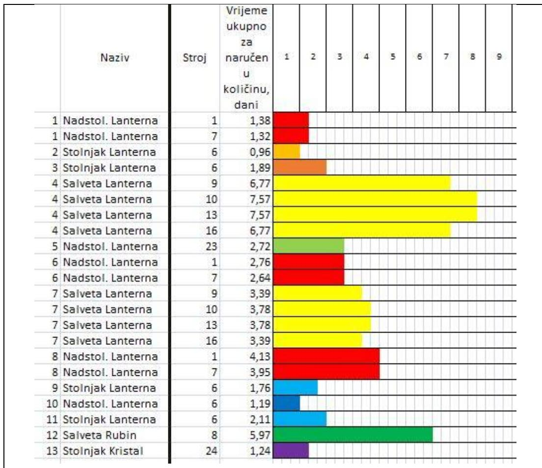
**Slika 26** Ukupno vrijeme proizvodnje artikala po strojevima
