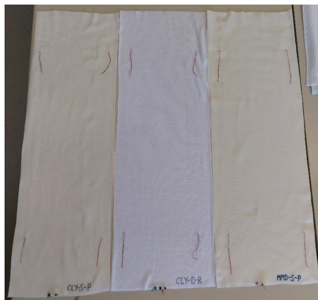
Slika 244. Epruvete načinjene za ispitivanje dimenzijske stabilnosti
