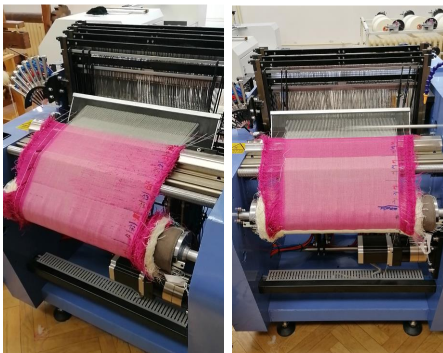
Sl. 36. Izrada uzoraka na tkalačkom stroju
