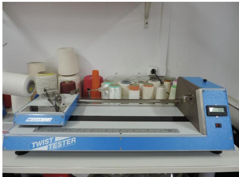
Sl. 35. Torziometar Twist tester za određivanje uvojitoosti pređe
