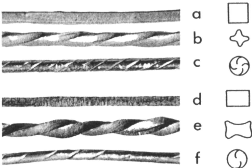
Slika 3: Proizvodnja žice uvijanjem metalnih blokova [22].
