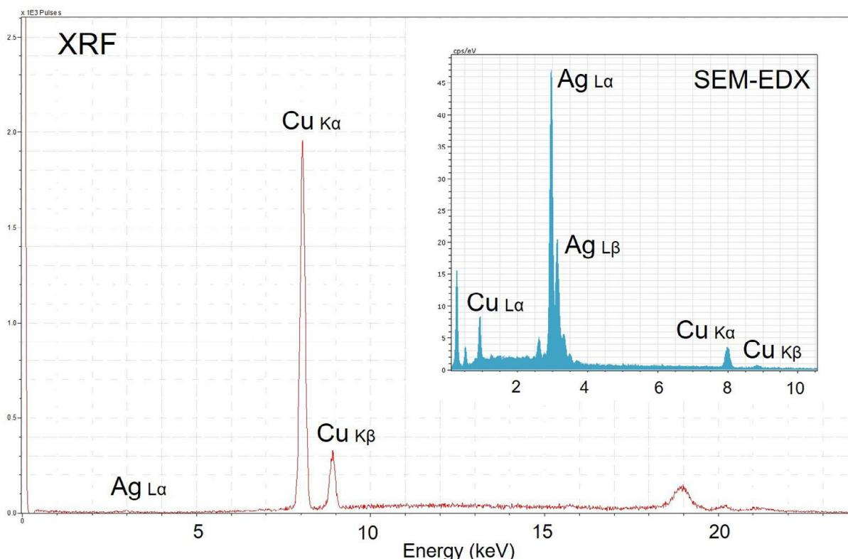
Slika 25: XRF i SEM-EDX spektar uzorka S11
