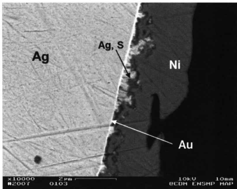
Slika 24: Presjek metalne lamele sa slojem nikla [122]
