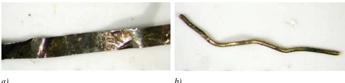
Slika 1: Samostalne metalne niti: a) lamele, b) žica [7, 21]
