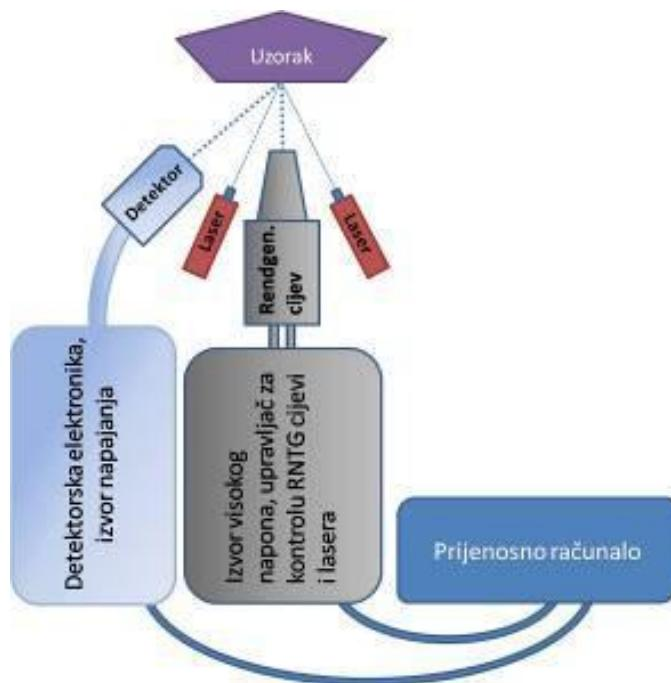
Slika 20: Shematski prikaz komponenti XRF instrumenta [79]
