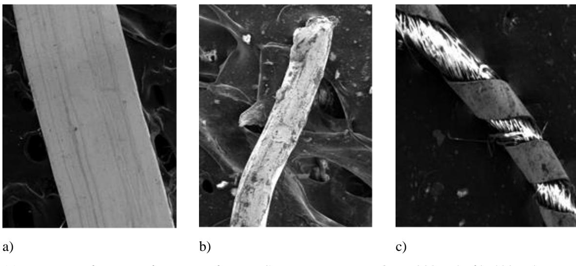
*Slika 15: Tri različite metalne niti analizirane SEM-EDX-om povećanje 200x a) i b), 100x c),
