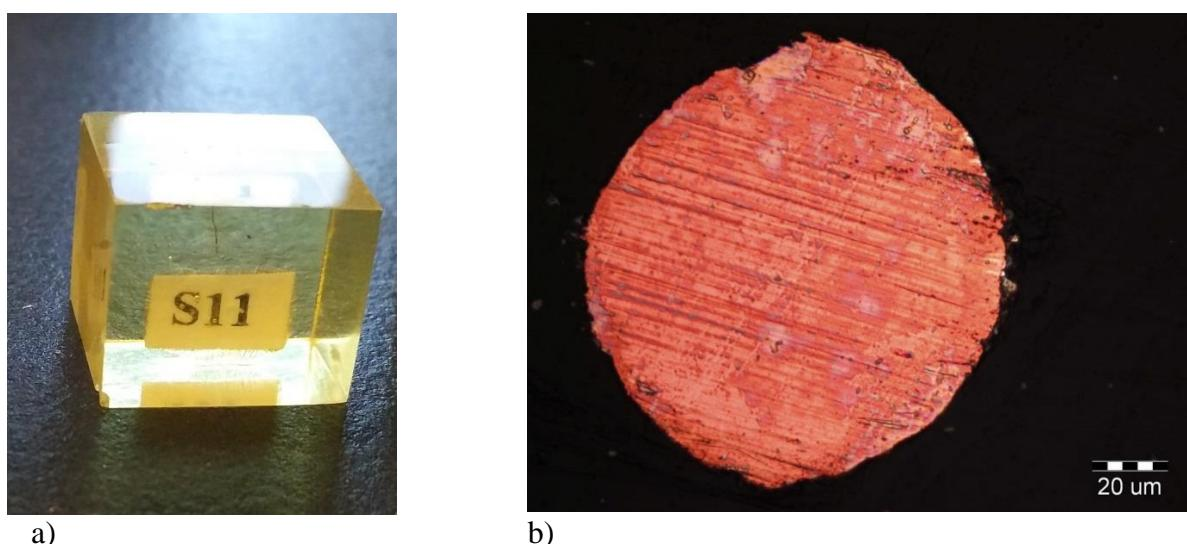
Slika 22: Poprečni presjek uzorka metalne niti iz Splita
