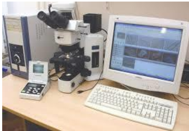
Slika 18. Oprema za izradu i analizu mikroskopskih slika vlakana (Izvor slike:
