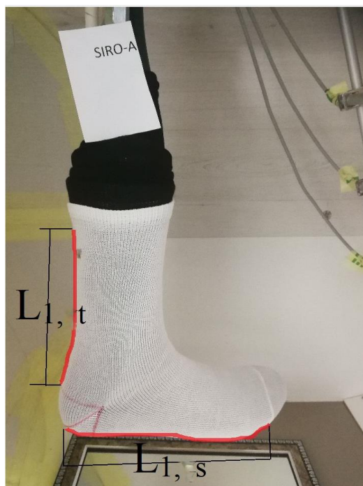
Sl. 52: Mjerenja parametara istezanja čarape po krivulji Termalnog stopala
