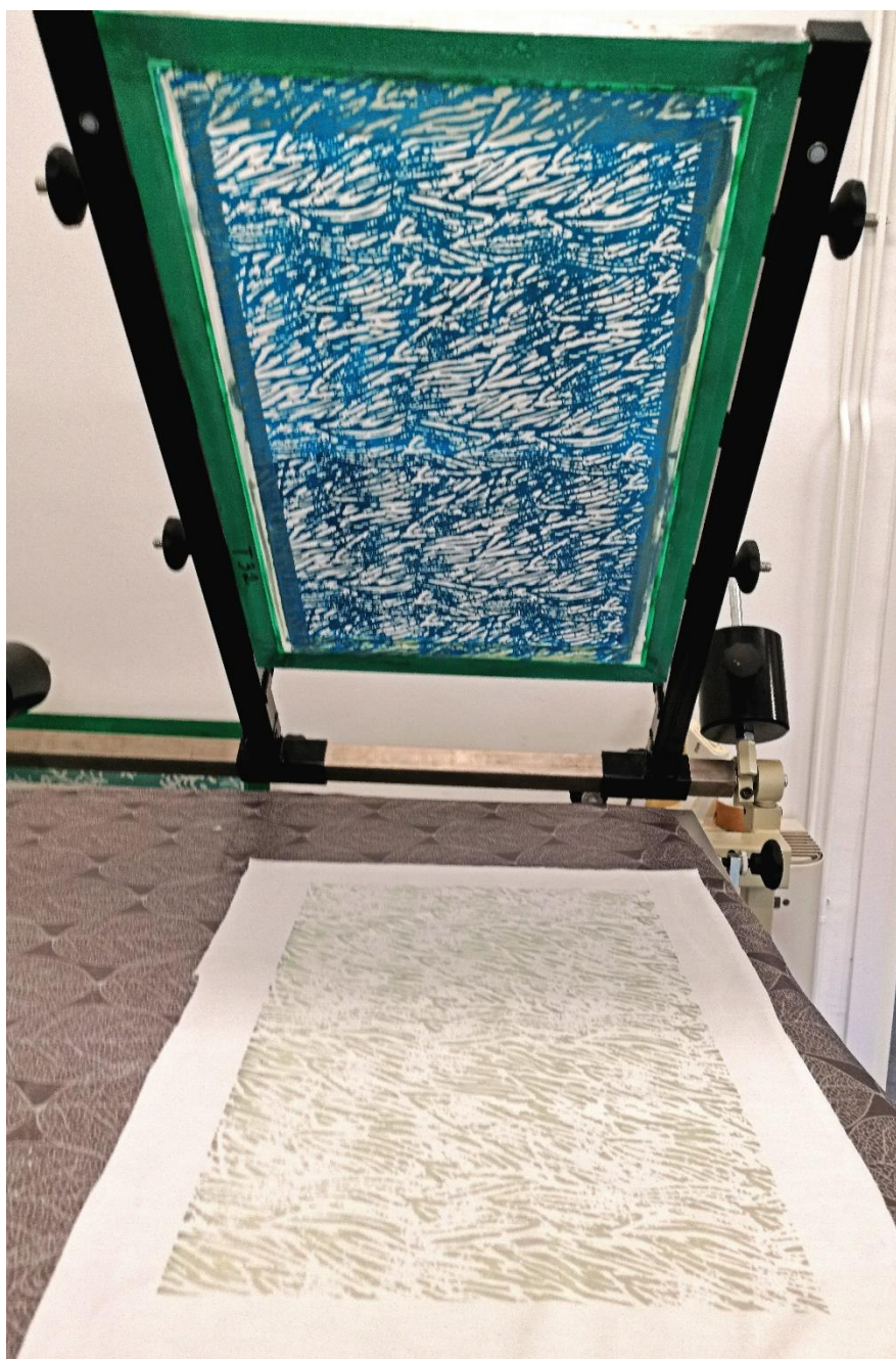
Sl. 15. Otisnuti uzorak i postavljena šablona na stolu za ručni sitotisak.
