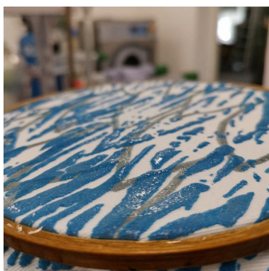
Sl.21. Prikaz vodoodbojnosti test 1.
