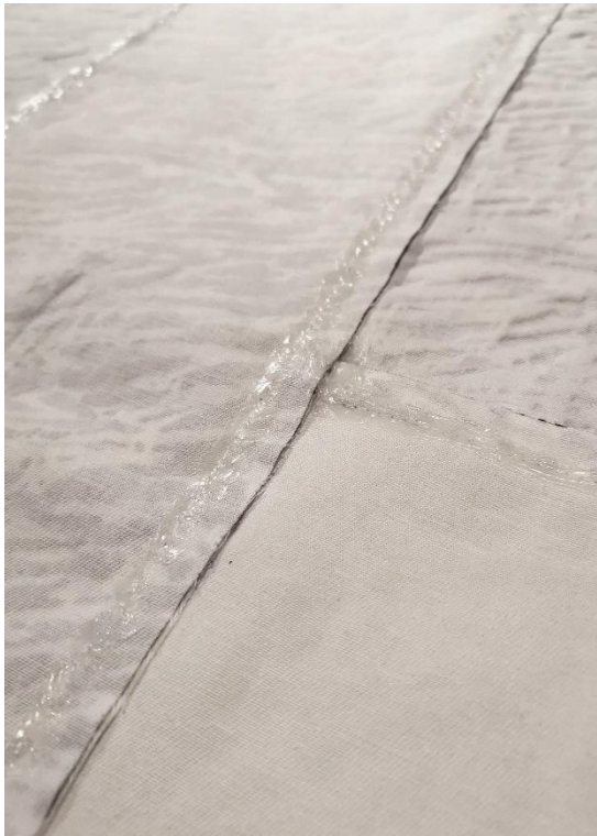
Sl.26. Lijepljeni šavovi.
