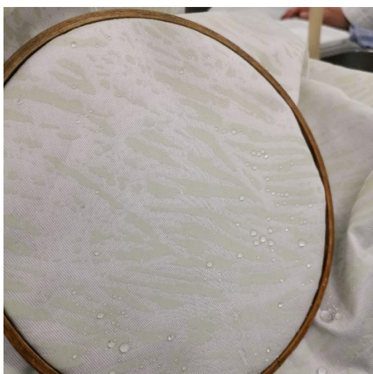
Sl.24. Prikaz vodoodbojnosti test 4.
