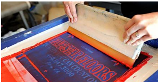
Slika 6: Prikaz tiska pomoću sita i šablone
