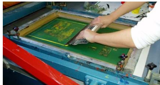
Slika 6: Prikaz tiska pomoću sita i šablone
