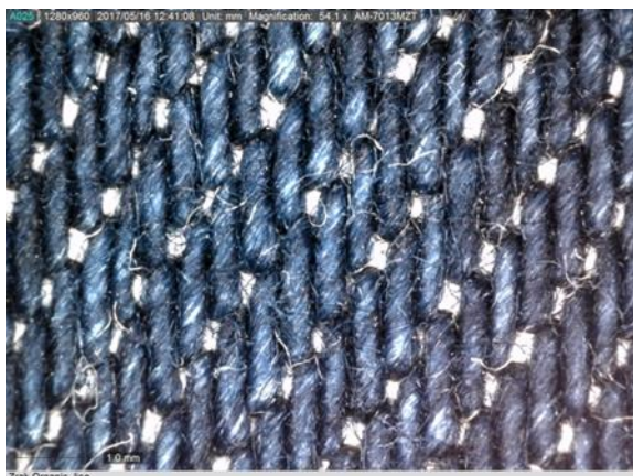
Slika 44: Uzorak džins tkanine obezbojene s organIQ Bleach uz naknadno sušenje na zraku - lice tkanine uz različita povećanja: a) 53.1 X; b) 235.2 X
