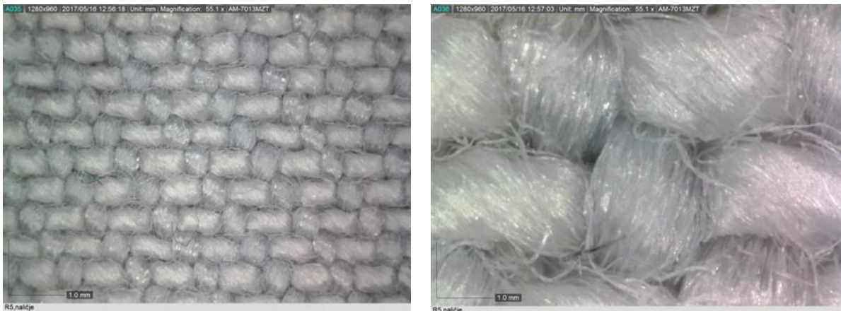
Slika 41: Uzorak džins tkanine obezbojene s \text{KMnO}_4 - naličje tkanine, vrijeme obrade 60 min, različita povećanja: a) 53.1 X; b) 235.2 X
