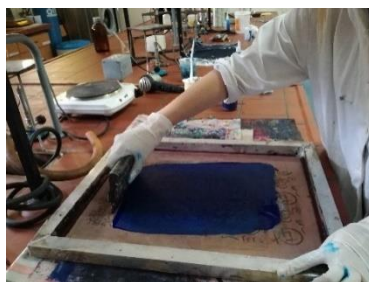
Slika 14: Preslikavanje uzorka pomoću šablone i rastirala
