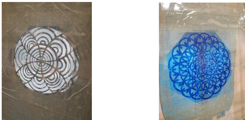
Slika 13: vidljivi uzorci na šablona gdje se tiskalo sa plavom i bijelom pastom
