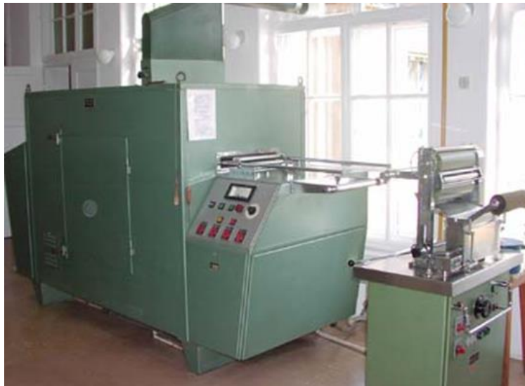
Slika 19: Rastezni sušionik s foulardom, Benz
