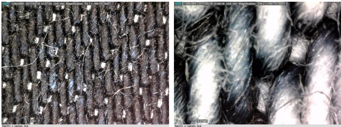
Slika 50: Uzorak džins tkanine obezbojene s vulkanskim kamenom kupanim s NaOCl - lice tkanine uz različita povećanja a) 53.1 X; b) 232.2 X
