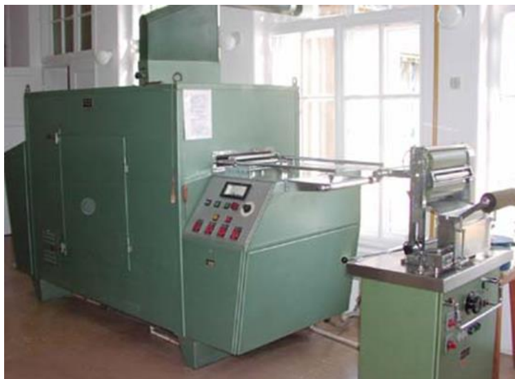
Slika 19: Rastezni sušionik s foulardom, Benz
