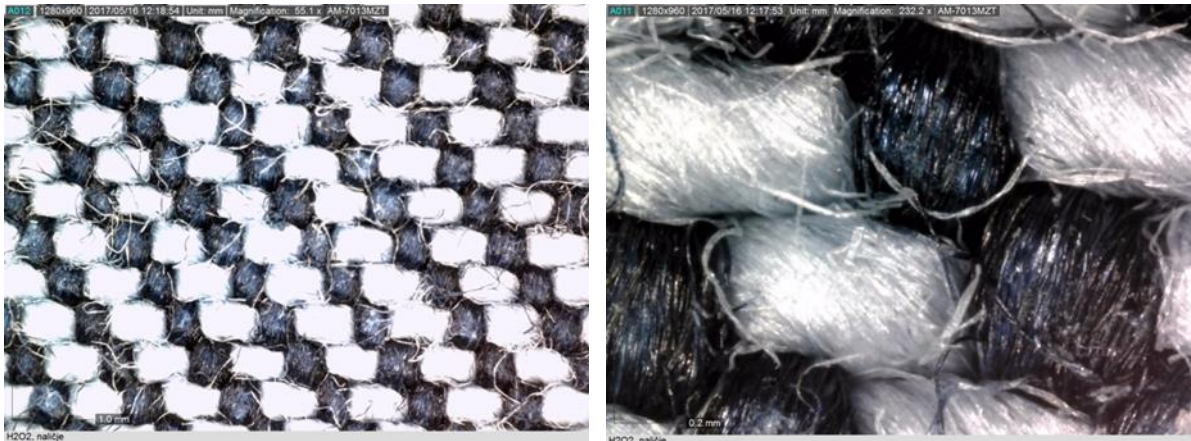
Slika 47: Uzorak džins tkanine obezbojene s H 2 O 2 - naličje tkanine uz različita povećanja a) 53.1 X; b) 232.2 X
