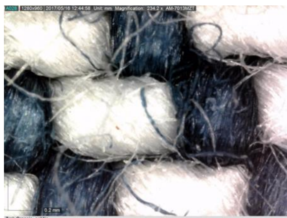
Slika 45: Uzorak džins tkanine obezbojene s organIQ Bleach uz naknadno sušenje na zraku - naličje tkanine uz različita povećanja: a) 53.1 X; b) 235.2 X
