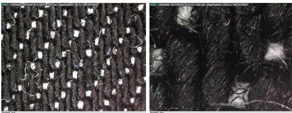
Slika 32: Neobrađeni džins – lice tkanine uz različita povećanja: a) 55.1 X; b) 232.2 X
