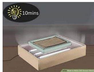
Slika 8: Osvjetljavanje folije na šablonu
