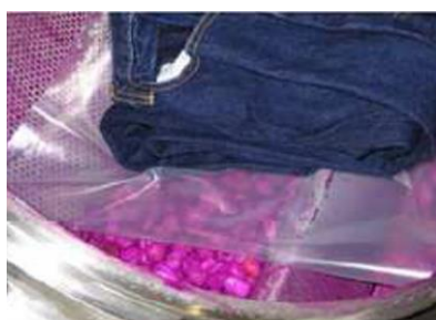
Slika 9: Namakanje kamena s KMnO_4 u tumbleru/bubnju stroja za obradu džinsa
