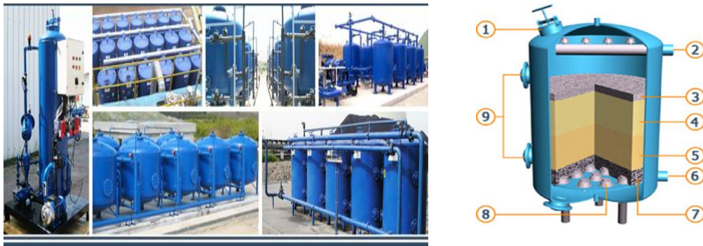
Slika 22. Izgled filtracijsko adsorpcijskih uređaja [43]
