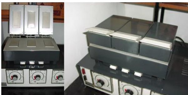
Slika 26. Termička preša Original Hanau 7501
