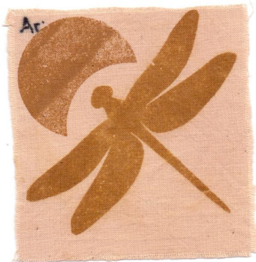
Slika 20. Uzorak predobrađen argonovom plazmom, bojadisan i tiskan - LUK
