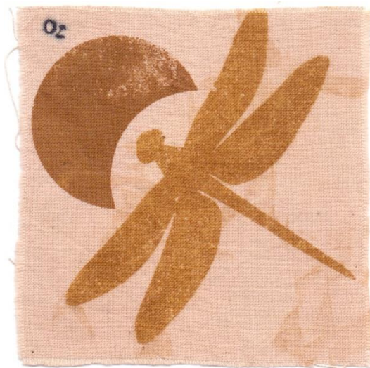
Slika 21. Uzorak predobrađen kisikovom plazmom, bojadisan i tiskan - LUK
