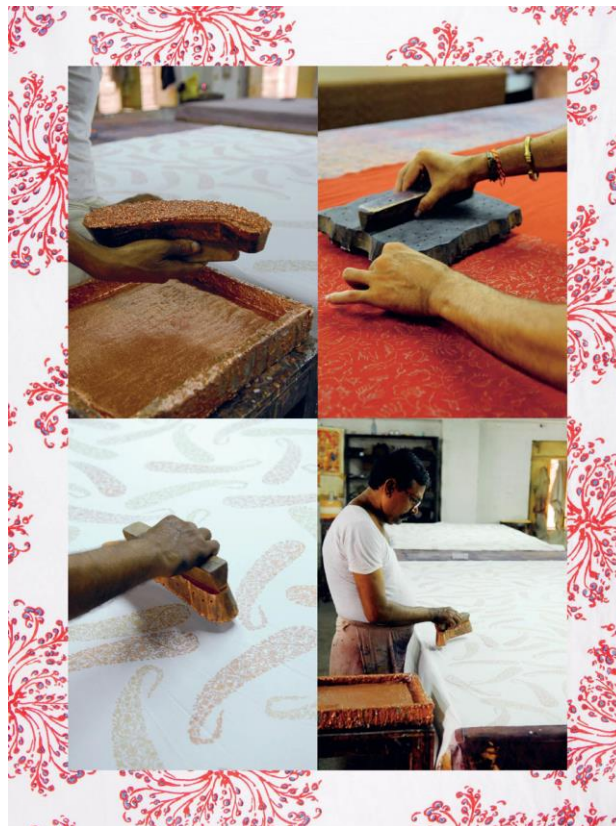
Slika 8. Postupak otiskivanja blokom na tekstu u manjoj radionici, Indija
