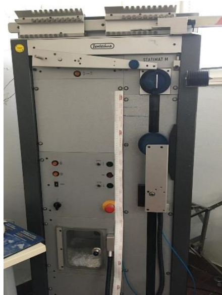
Sl. 10. Dinamometar sa stezaljkama za ispitivanje pređe
