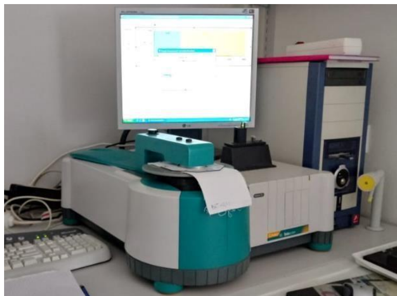
Slika 11. Transmisijski spektrofotometar Cary 50/Soloscreen (Varian)
