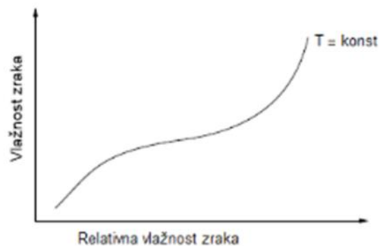
Slika 3. Ovisnost ravnotežne vlažnosti materijala o relativnoj vlažnosti zraka (IZVOR: Wernecke i Wernecke, 2014.)
