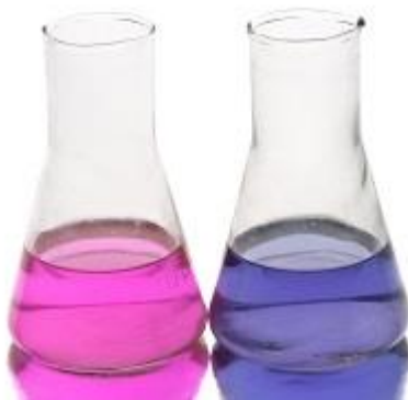
SI.4. Otopina [\text{Co}(\text{H}_2\text{O})_6]^{2+} i [\text{CoCl}_4]^{2-} [8]
