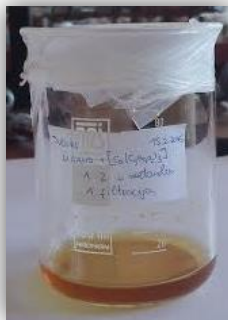
Sl.31. Matičnica nastala reakcijom 1H-benzimidazol-2-metanola i tris(2,4-pentandionato) kobalta(III) u molarnom omjeru 1:2 u metanolu
