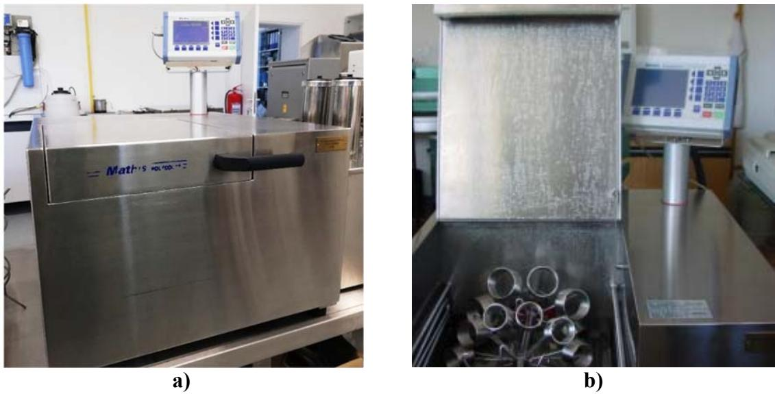
**Slika 47.** Uređaj za obradu uzoraka Turbotest, P 4502, Mathis, Švicarska: a) vanjski izgled; b) unutarnji dio
