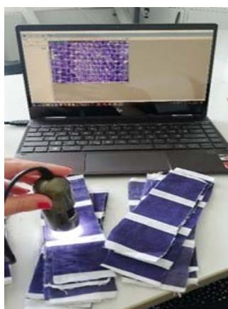
**Slika 46.** Mjerenje uzorka pomoću Dino-Lite digitalnog mikroskopa
