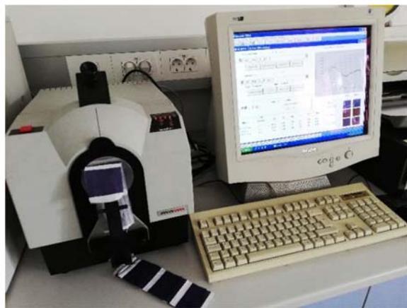
Slika 43. Remisijski spektrofotometar, Spectraflash SF 600 PLUS-CT, Datacolor
