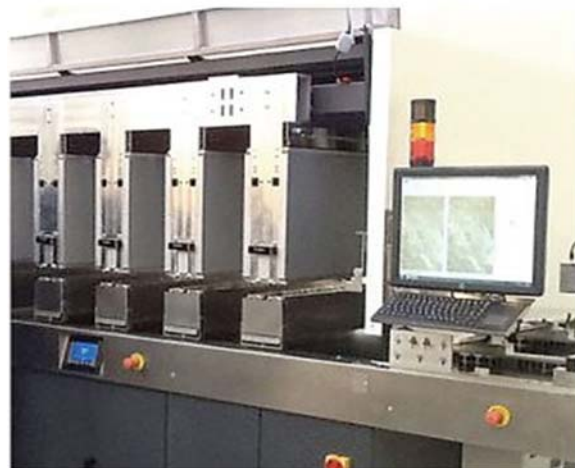
Slika 29. Tekstilni Ink Jet stroj KERAtex [16]
