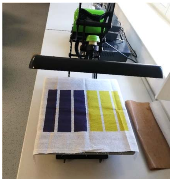
Slika 41. Fiksiranje vrućim zrakom pomoću termo preše
