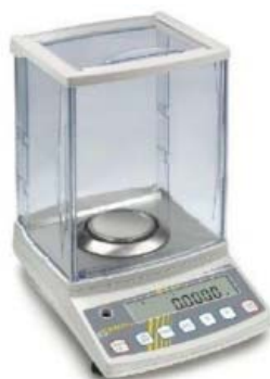
Slika 38. Analitička vaga s točnošću od \pm 0,0001 \text{ g}
