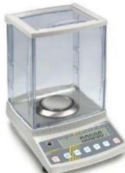
Slika 38. Analitička vaga s točnošću od  $\pm 0,0001 \text{ g}$
