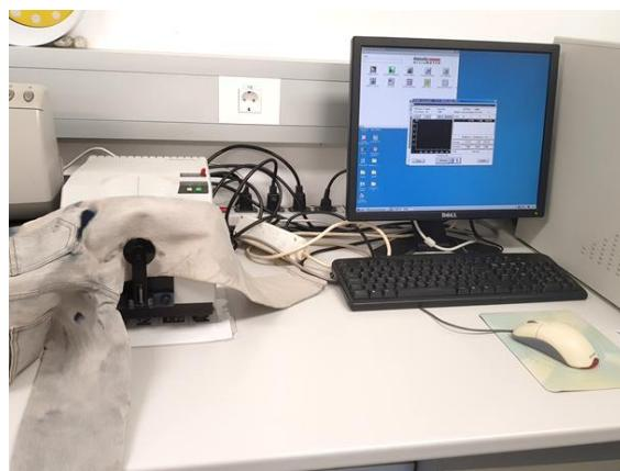
**Slika 26.** Remisijski spektrofotometar Spectraflash SF 300, tt. Datacolor
