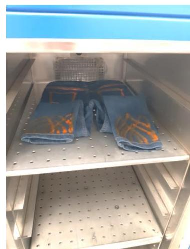
**Slika 23.** odjevni predmet pripremljen za sušenje i kondenzaciju
