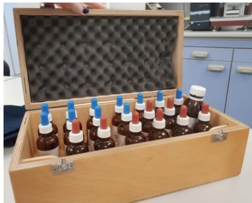
Slika 27. Ispitne kapljevine za ispitivanja vodo- (plavi poklopac) i uljeodbojnosti (smeđi poklopac)
