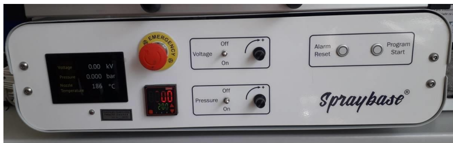
Slika 23. Ploča za podešavanje procesnih parametara.
