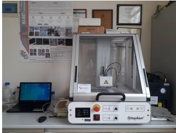
Slika 22. Uređaj za elektroispredanje iz polimerne taline, Spraybase®.
