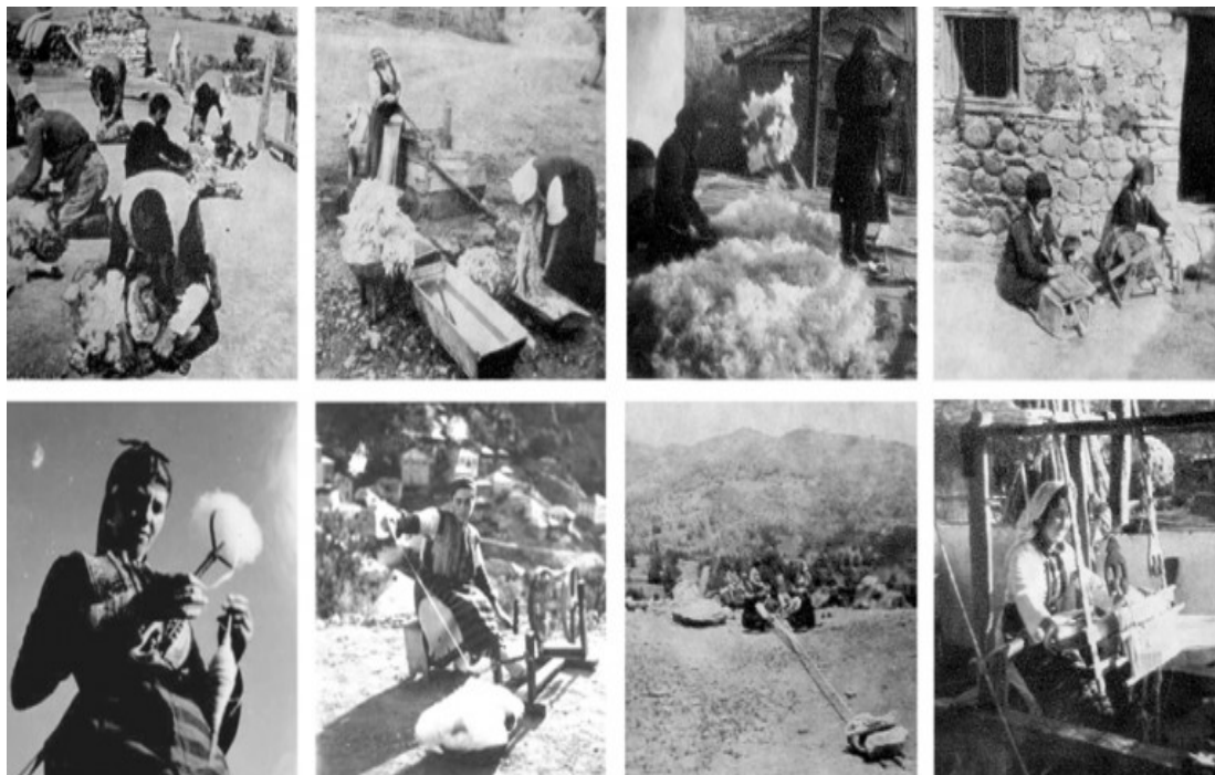
Sl. 2. Proces izrade tkanine od striganja ovaca do tkanje na tkalačkog stana
