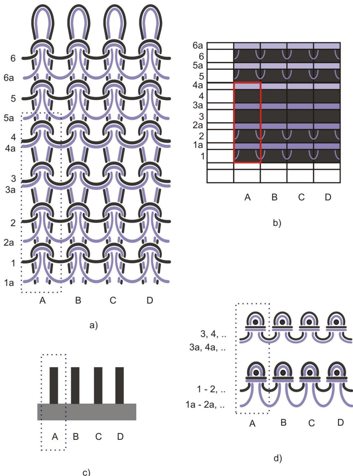
Slika 9. Desno-ljevi kulirni pliš preplet s platirnim vodoravnim prudama 2+2:
