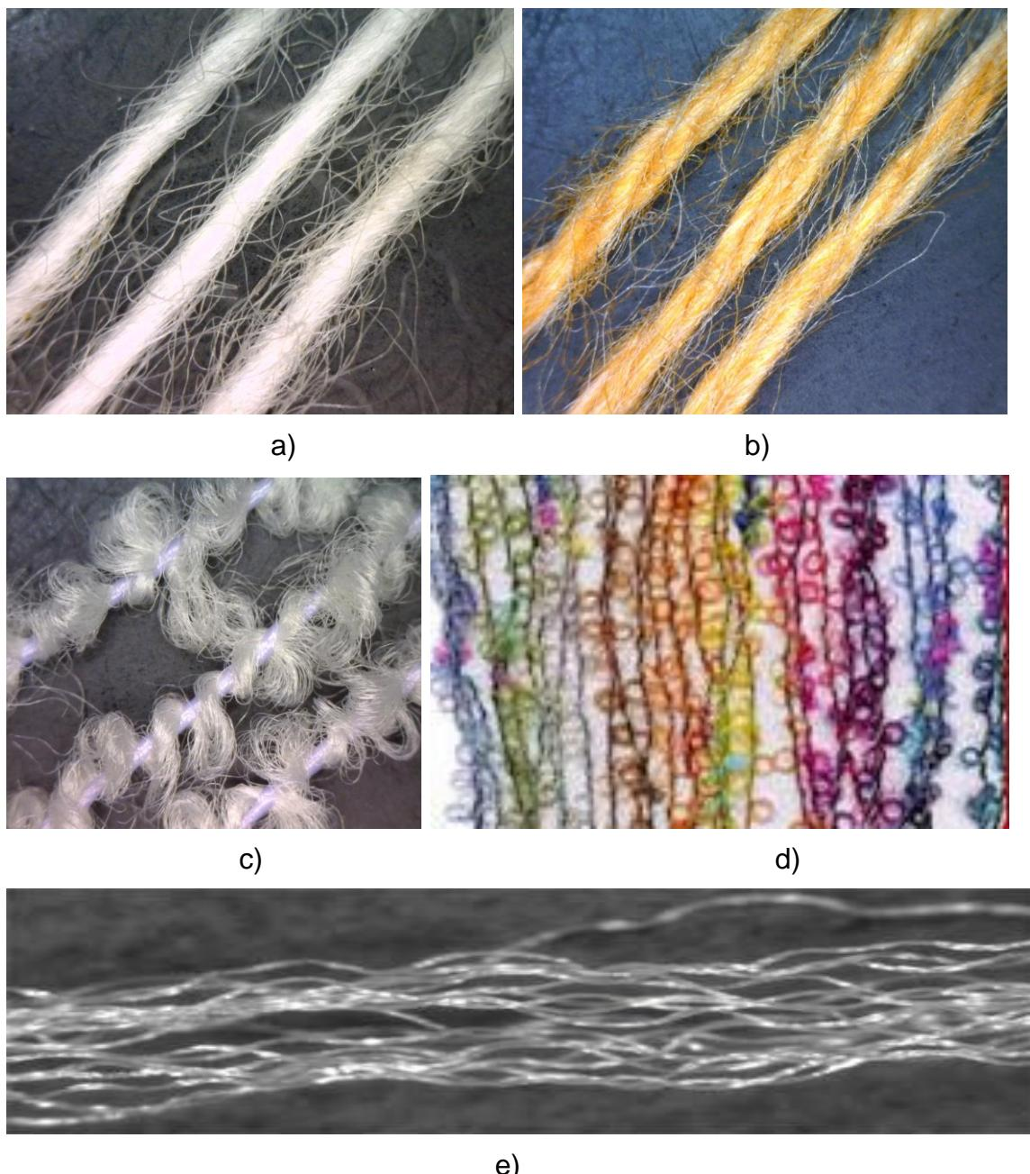
Slika 7. Različite pređe za izradu pletiva: a) pamučna, jednostruka, b) pamučna, končana, c) efektna, jednoboјna, d) efektna višebojna i e) multifilamentna PA pređa
