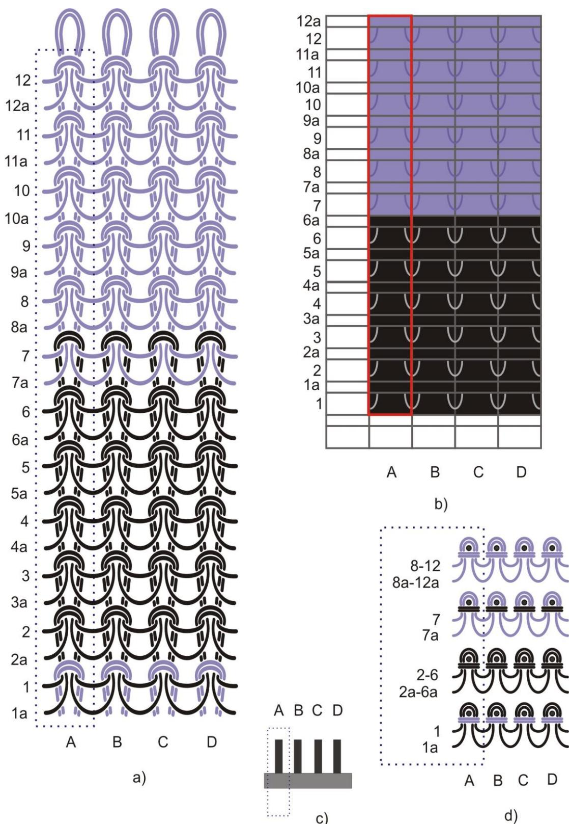
Slika 10. Desno-ljevi kulirni pliš preplet s višebojnim vodoravnim prugama 6+6:
