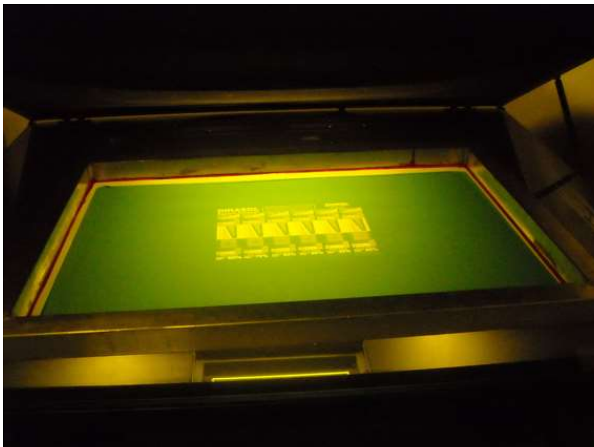
Slika 7: Osvjetljavanje sita premazanog fotoemulzijom
