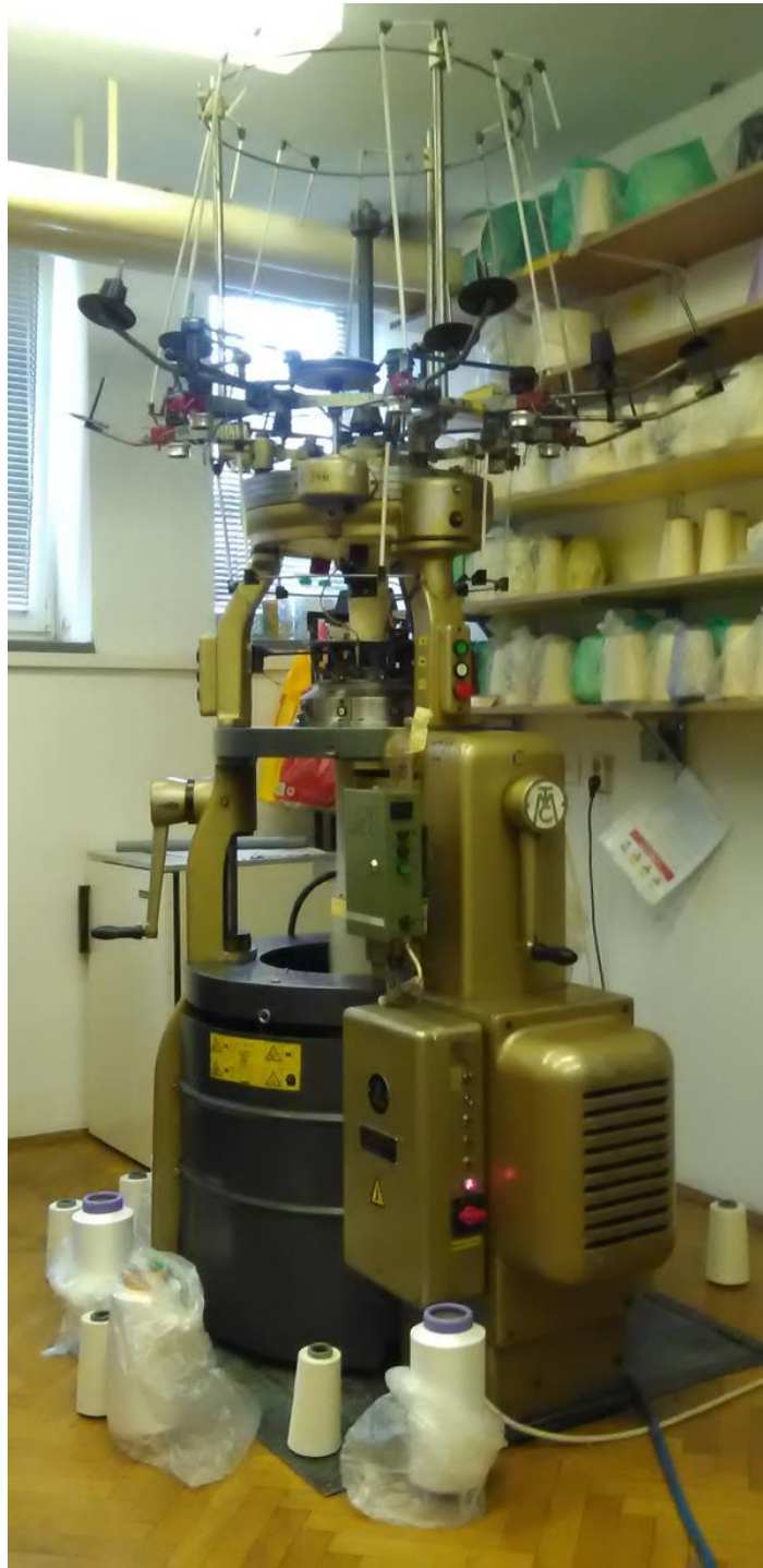
Sl. 5. Kružnopletaći dvoiglenični stroj na kome su izrađivani uzorci pletiva
